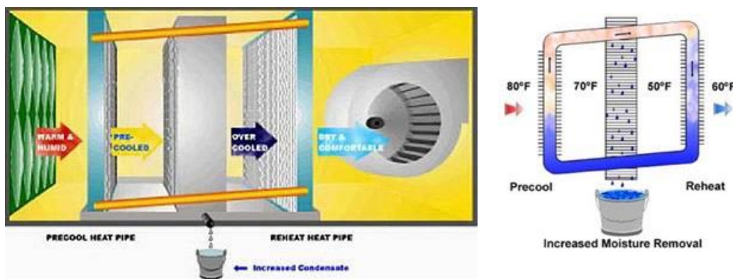
รูปที่ 4-15 การติดตั้งท่อความร้อนในเครื่องส่งลมเย็น
