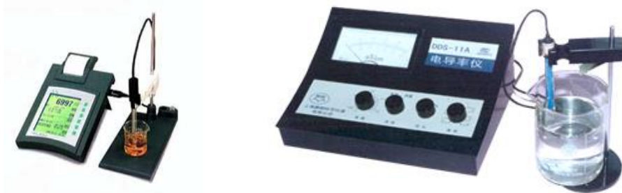
รูปที่ 1-21 เครื่องมือวัดสภาพการนำไฟฟ้าของน้ำ
