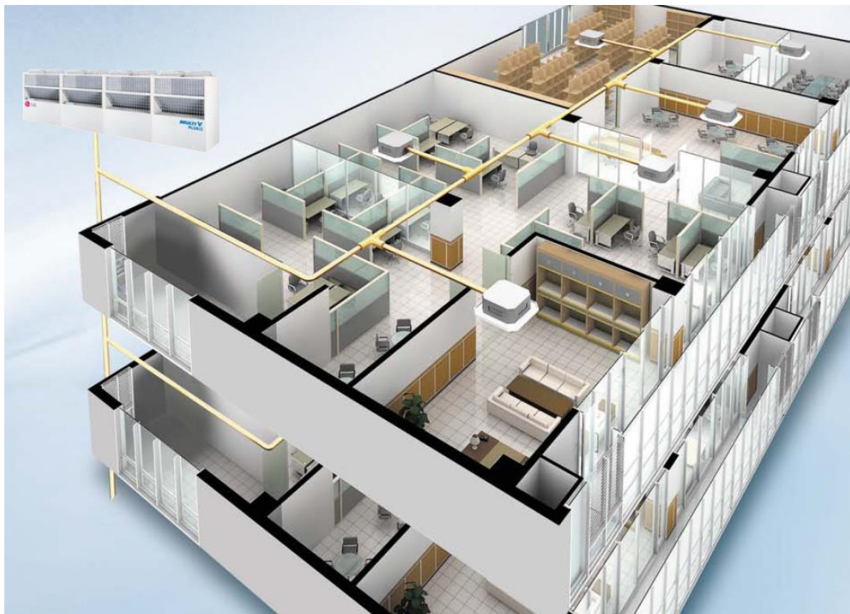
ภาพแสดงตัวอย่างระบบ VRF (VARIABLE REFRIGERANT VOLUME)
