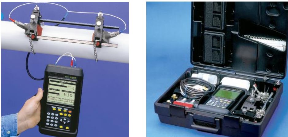
รูปที่ 1-16 การวัดอัตราการไหลแบบอัลตราโซนิก
