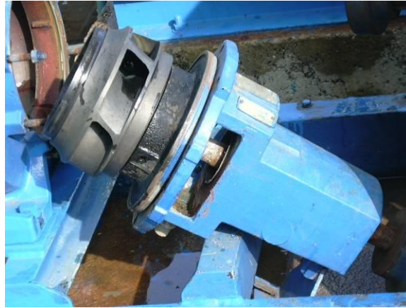
รูปแสดงมอเตอร์ปั้มน้ำขนาด 55 kW
