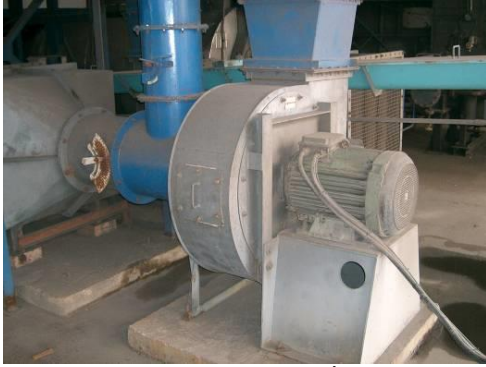
รูปที่ 6-28 พัดลมเป่าทรายและการปรับหรีดแอมเปอร์
