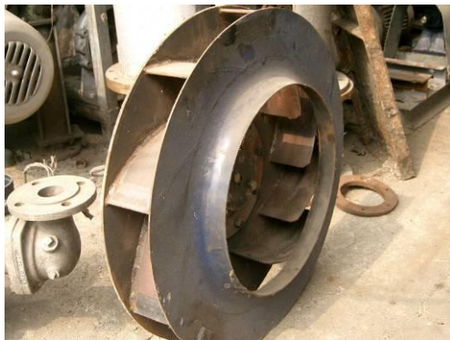
รูปที่ 6-29 ใบพัดของพัดลมเป่าทรายอันใหม่และการปรับแอมเปอร์พัดลมใหม่ (หรีดให้น้อยลง)
